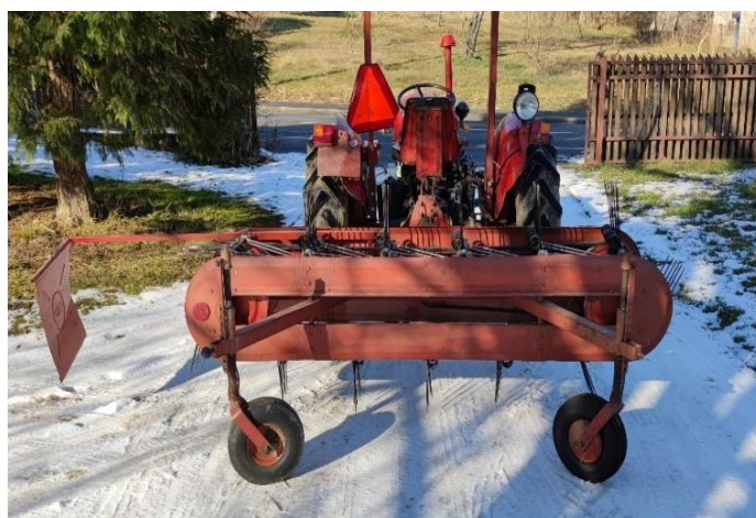
Slika 5. Okretač sijena s beskrajnom trakom i elastičnim zupcima
