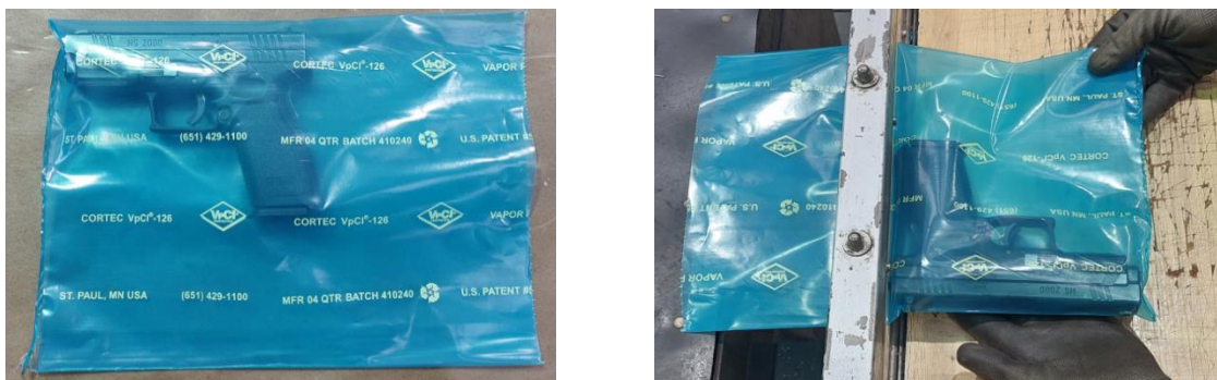
Slika 11: Umetanje oružja u polietilenske vrećice i hermetizacija
