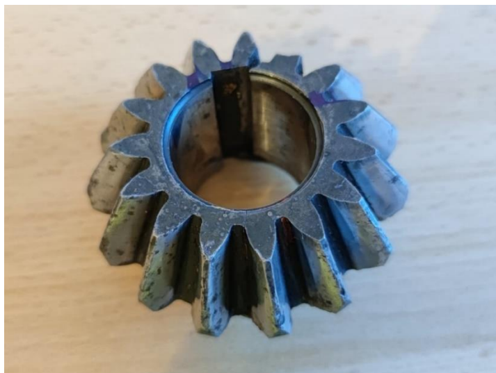
Slika 7. Tragovi trošenja po cijelom obodu stožnika
