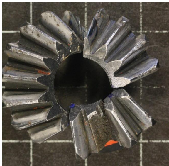
Slika 11. Izrezani dijelovi oštećenog stožnika
