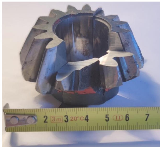
Slika 12. Preostali dijelovi stožnika na originalnim pozicijama
