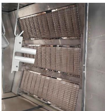
Slika 1: Infracrvena (IC) komora za sušenje tekućih premaza, Pilot postrojenje tvrtke Končar – Metalne konstrukcije
