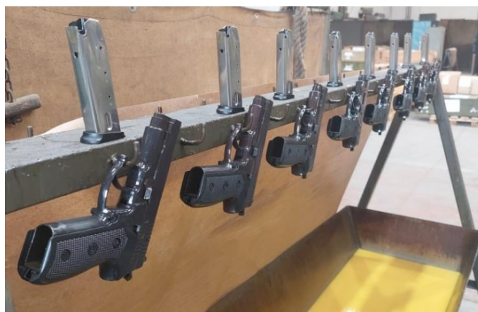
Slika 10: Cijeđenje i sušenje oružja
