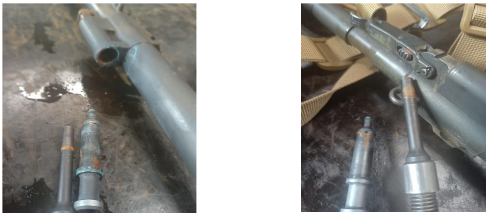
Slika 3: Pojava korozije na klipu plinskog cilindra uslijed neadekvatnog čišćenja oružja
