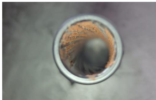
Slika 4: Korozijska cijevi vatrenog oružja kalibra 9 mm
