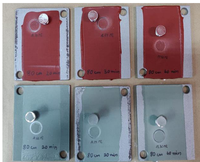
Slika 7: Pull-off vrijednosti prionjivosti EPw i PUw premaza sušenih na 80 cm od IC panela
