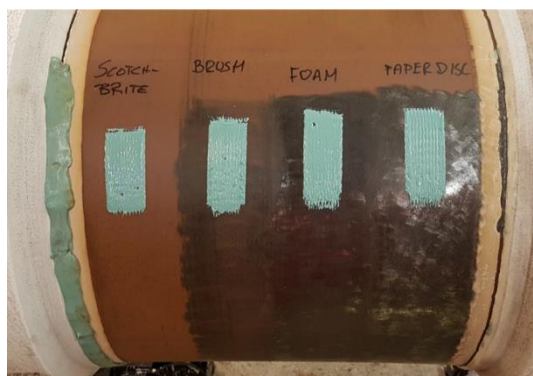
Slika. 4: Priprema površine za aplikaciju [3]
