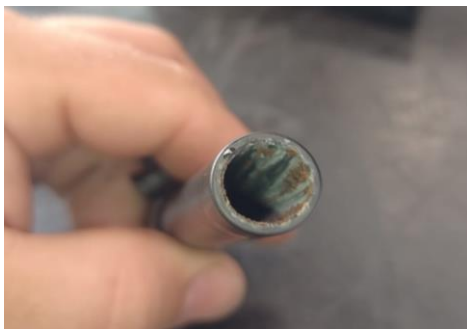
Slika 4: Korozijska cijevi vatrenog oružja kalibra 9 mm
