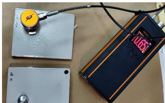
Slika 4: Ispitivanje adhezijskih svojstva uređajem Elcometer 510
