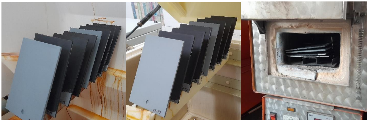
Fig. 1: Uzorci spremni za ispitivanje (redom: slana komora, vlažna komora, peć)
