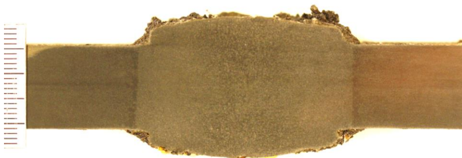
Slika 13. Prikaz makrostrukture u vratu tračnice bez nepravilnosti
