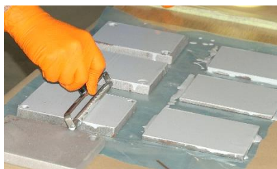
Slika 2: Nanošenje premaza ručnim aplikatorom na ispitne pločice
