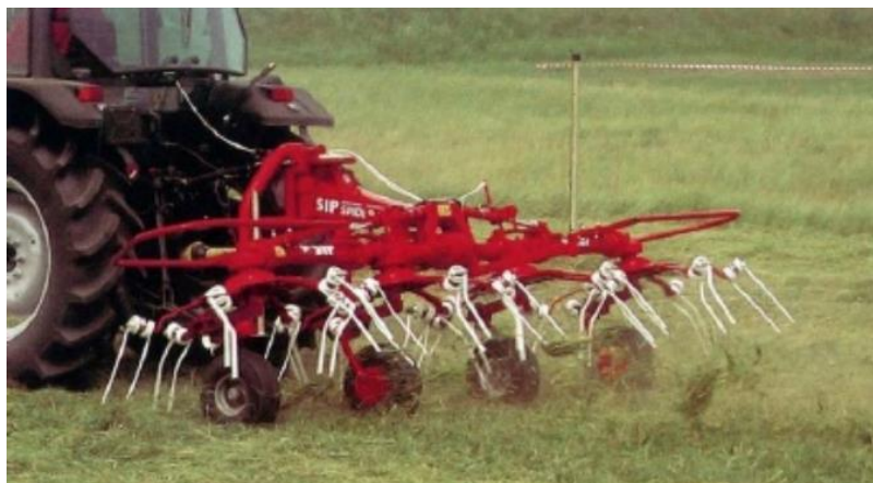
Slika 2. Rotacijski okretač-rastresač proizvođača SIP [1]
